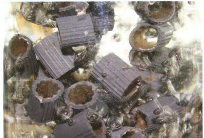
Füllkörpermaterial EvU®-Pearl neu installiert
